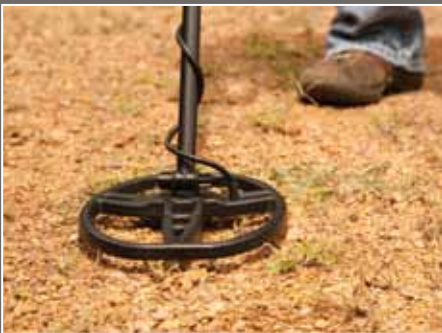
Neue DD-Sonde bietet bessere Ortungstiefe auf mineralisierten Böden.
